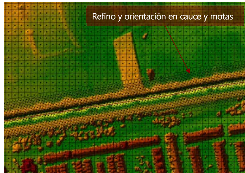
Imagen 14 – Detalle discretización malla de cálculo.
